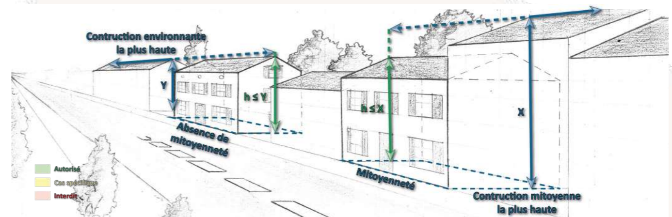
Schéma 5 : Hauteur des constructions, cas particulier (Article UA10, Paragraphe 3) :
