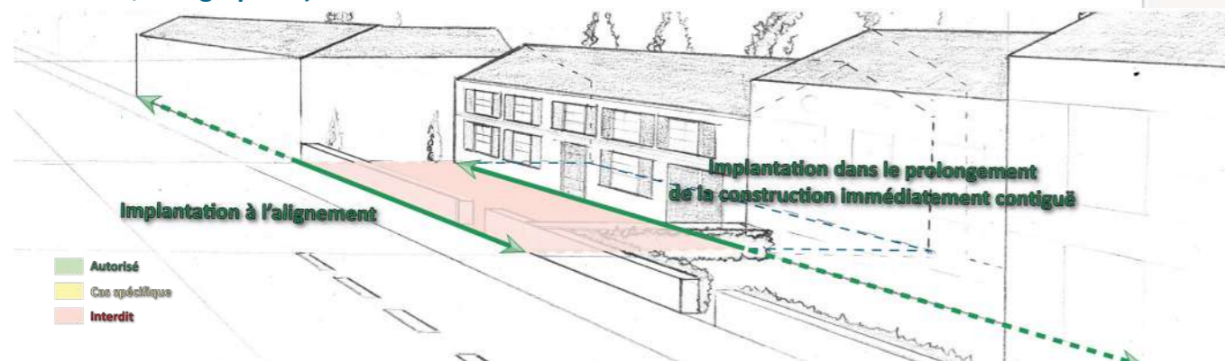
Schéma 2 : Implantation des constructions par rapport aux limites séparatives (Article UA7)
